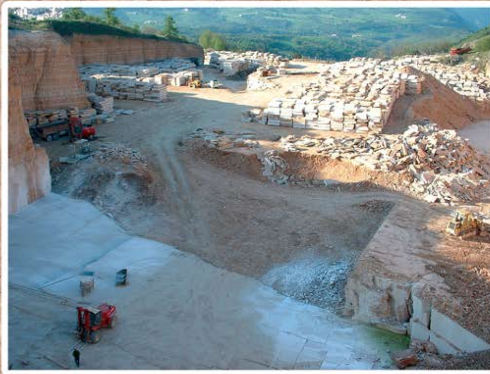
AUSSCHNITT DES STEINBRUCHES "SAN GIOVANNI LOFFA". MAN SIEHT DIE ABBAUOBERFLÄCHE SOWIE DIE FÜR DEN ABTRANSPORT ZUR WEITERVERARBEITUNG ZWISCHENLAGERTEN PLATTEN.
