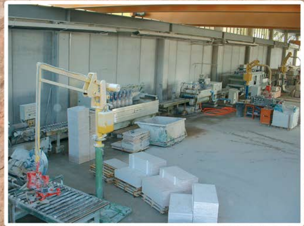
PRODUKTION VON BODENBELÄGEN FÜR DEN INNEN- UND AUßENBEREICH. MAN SIEHT DIE MASCHINEN ZUR VERARBEITUNG UND ZUR FORMATIERUNG VON FLIESEN, SOWIE DAS ENDPRODUKT.
